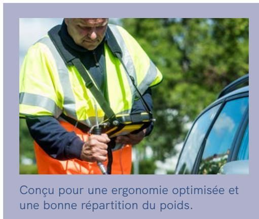
déterminer rapidement si le gaz détecté provient d'un tuyau qui fuit, d'autres sources de gaz naturel ou de gaz de marais (Bio-méthane issu de la décomposition organique). Le CPG intégré à IRwin fournit des résultats d'analyse rapides, même à de faibles concentrations d'éthane (à partir de 0,5 %).
